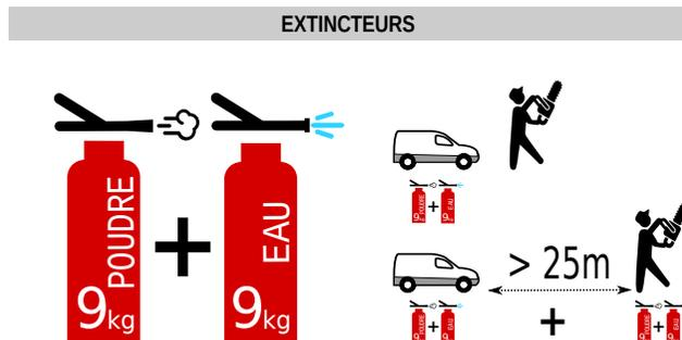
**Engins de chantier avec broyeur, moissonneuse**
